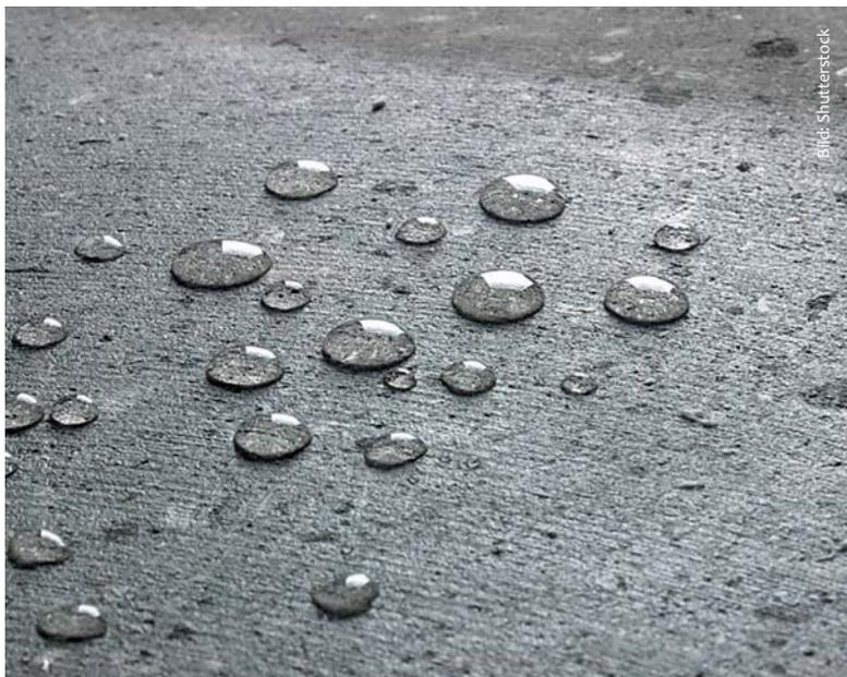
Untersuchungen haben gezeigt, dass bei Bau- und Werkstoffen, die mit veritablen Nanoversiegelungen behandelt wurden, die Wasseraufnahme verhindert oder stark reduziert werden konnte.
